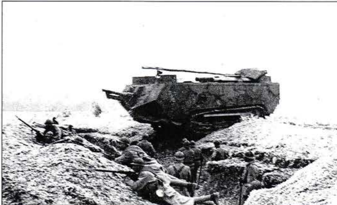
Char Saint-Chamond équipé d'un canon de 75 mm et 4 mitrailleuses
